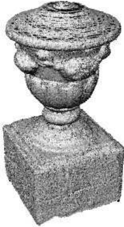
Abb. 2 - Ergebnis des 3D-Scans eines Pokals als Punkt-Wolke
